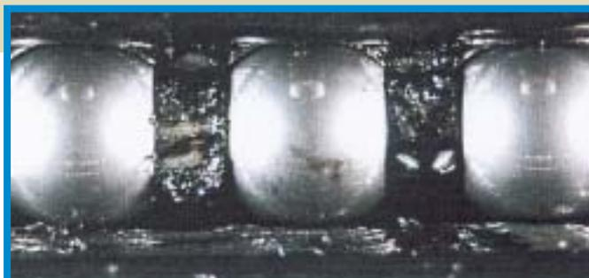
Aucune altération de la graisse (quantité et aspect) et billes en parfait état.
