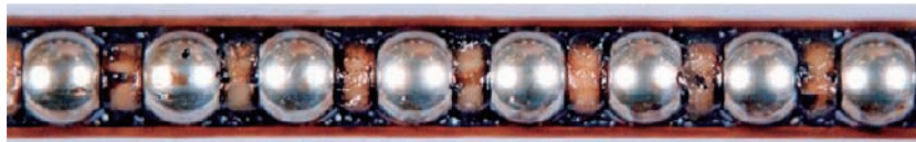
Kugelkette nach 8.000 km Laufstrecke (Teststopp) mit ausreichend Schmierfett
