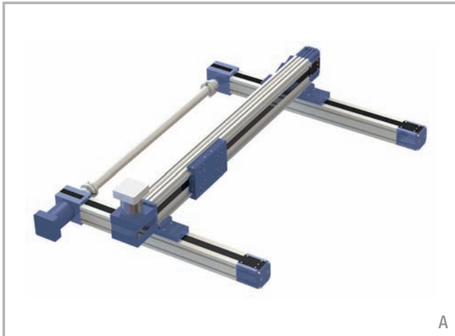
A - Lineareinheiten: - Achse X: 2 ELM 80 SP - Achse Y: 1 ROBOT 160 SP Notwendige Verbindungselemente: 2 Sets Verbindungswinkel für die Montage der Einheit ROBOT 160 SP auf den Laufwagen der Einheiten ELM 80 SP.
