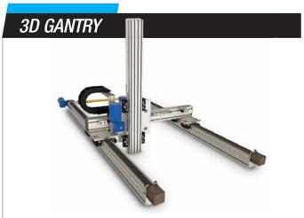
Système 3 axes X-Y-Z idéal pour différentes applications (palettisation...). Le guidage est assuré soit par des galets soit par des patins à recirculation de billes montés sur des surfaces usinées pour une meilleure précision.
