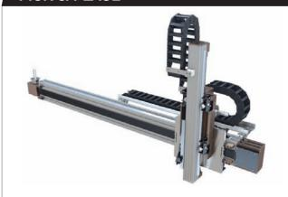
Système Y-Z idéal pour les applications de Pick & Place. Le préhenseur se fixe directement à l'extrémité de l'axe Z ou par l'intermédiaire d'une plaque d'interface. Le guidage est assuré soit par des galets soit par des patins à recirculation de billes montés sur des surfaces usinées pour une meilleure précision.
