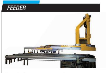
Système d'alimentation de machines (presses...) ayant un encombrement réduit et autorisant des cycles élevés. Mouvement horizontal par axe linéaire téléscopique à plusieurs étages, entraînement par courroie et guidages avec patins à recirculation de billes. Mouvement vertical par vis à billes ou système bielle/manivelle.
