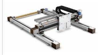
Système X-Y avec deux axes X synchronisés et un axe Y monté sur le chant dont le chariot peut être adapté à la demande. Le guidage est assuré soit par des galets soit par des patins à recirculation de billes montés sur des surfaces usinées pour une meilleure précision.
