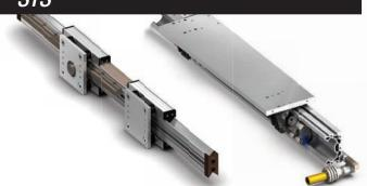
Système modulaire de transfert composé de profilés en alliage d'aluminium aux caractéristiques mécaniques élevées, avec surface durcie (anodisation dure et profonde) et de guidages par boîte à galets. De par sa conception, l'encombrement est réduit et les guidages sont protégés. Plusieurs configurations sont disponibles en fonction des charges et de la distance entre deux points d'appui. Il peut s'intégrer avec des profilés structurels et dispose d'une vaste gamme d'accessoires.
