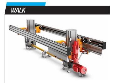
WALK est un système de translation à pas de pèlerin. Le mouvement horizontal est réalisé par un entraînement pignon/crémaillère. Le guidage est assuré par des galets montés dans un profilé aluminium avec une anodisation dure. Le mouvement vertical est fait par deux unités à entraînement par vis à billes. Un seul motoréducteur est utilisé pour le mouvement vertical des deux axes (transmission avec un arbre et renvois d'angle).
