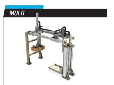
Système X-Y-Z sur-mesure avec entraînement par courroie, crémaillère, vis à billes. De part l'ampleur de la gamme, nous réalisons en collaboration avec nos clients des systèmes personnalisés répondant parfaitement à leur cahier des charges.
