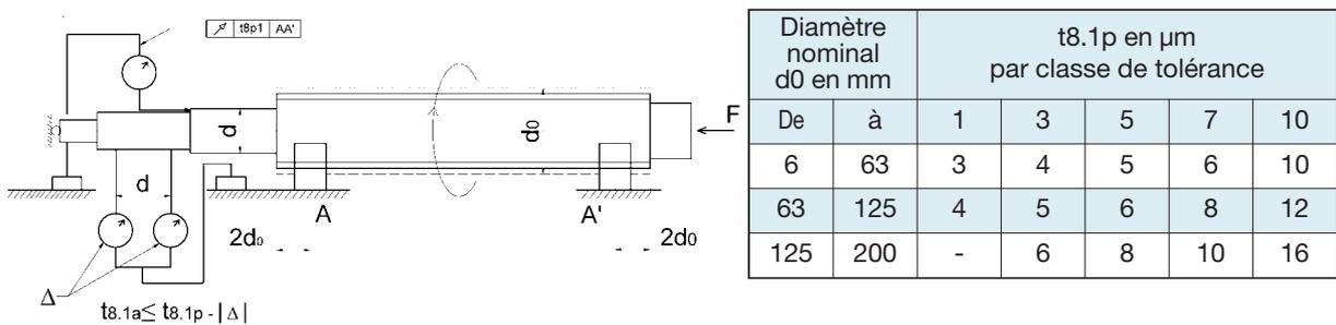
Battement axial  $t_{9p}$  de la surface d'appui de l'écrou par rapport à l'axe AA' (uniquement valable pour les écrous préchargés)
