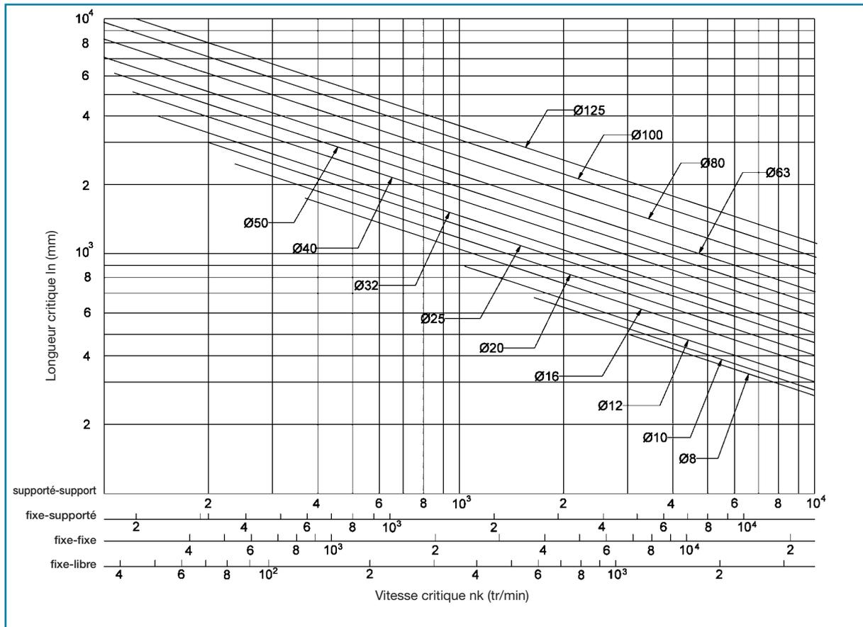
Comme tout axe en rotation, les vis à billes doivent tourner en dessous d'une valeur de vitesse critique. La vitesse critique est fonction du diamètre de la vis, de la configuration du montage et de sa longueur  $l_n$ .
