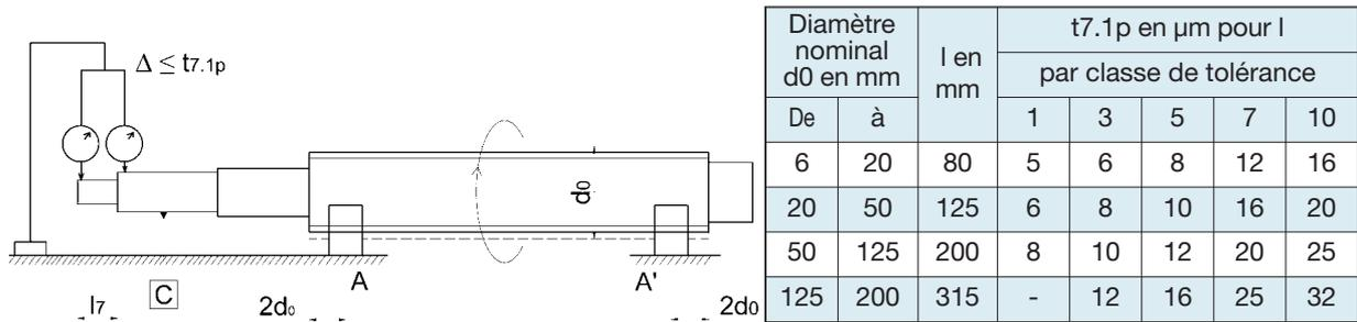
Battement axial  $t_{8.1}$  de la surface d'appui de roulement par rapport à l'axe AA'
